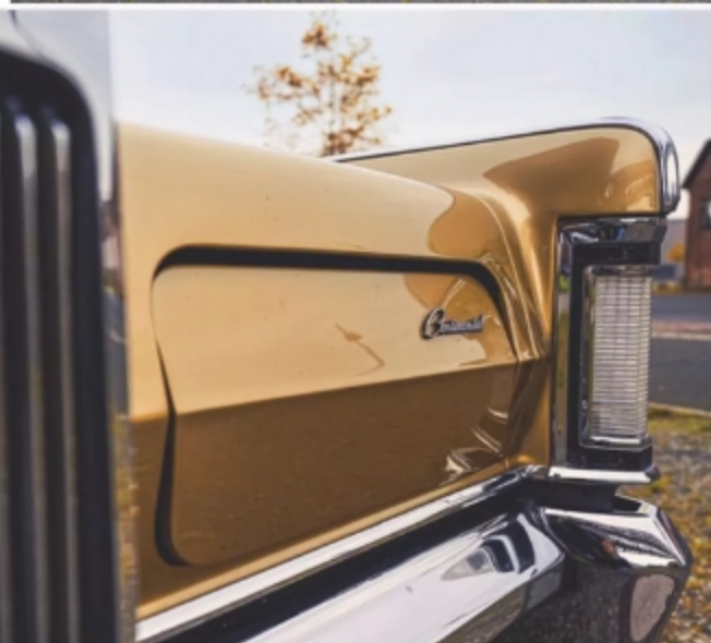
Über ein Unterdrucksystem gesteuerte Scheinwerferklappen geben der Continental-Front einen klaren und aufgeräumten Look
